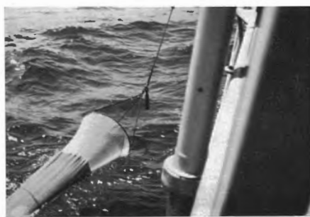
FIG. 2. — Le filet pélagique attaché au tangon.
