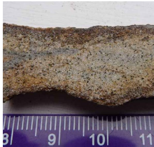
Figuur 4. Zevenkerke verwering en roestkleuring.
