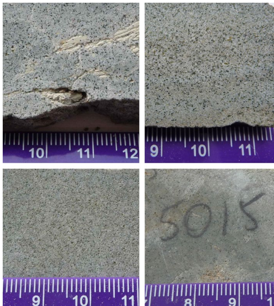
Figuur 3. Boven: veldsteen grove glauconiet in monster uit Geraardsbergen links/Beernem rechts. De crèmekleurige insluitsels zijn klasten van porcelaniet (verkiezelde klei). Onder: veldsteen met fijne glauconiet in monster uit Flobecq foto links en Knokke foto rechts.
