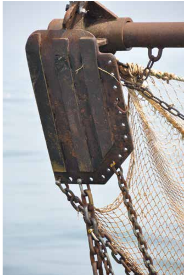
Figuur 4. Uiteinde van een boomkor met slof en kettingen (deel van de boomkor dat over de bodem sleept).
