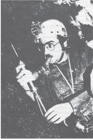
**Figure 31.** Dispositif pour empêcher l'arrivée d'air expiré par l'opérateur lors de mesures en milieu très confiné. L'opérateur aspire l'air de la grotte mais une soupape l'empêche de l'expirer vers l'extérieur; une autre soupape, fonctionnant à l'expiration, envoie l'air expiré dans un réservoir à chaux sodée qui absorbe le CO<sub>2</sub> anthropique. Pour obliger l'opérateur à respirer par la bouche, un pince-nez de natation lui bouche le nez.
