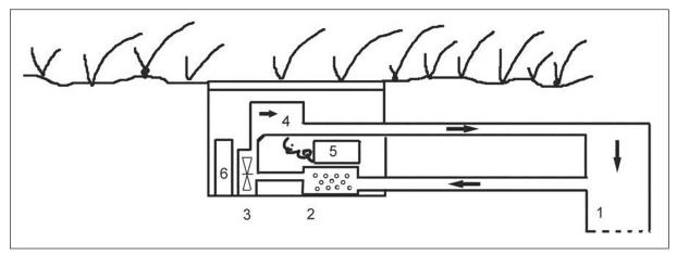
**Figure 8.** Schéma d'installation dans le sol du data logger en circuit fermé Do it yourself Omega. 1. Récipient perforé à la base et relié à l'enregistreur par des tuyaux souples. 2. Cartouche de silicagel. 3. Turbine à air. 4. Module électronique : régulateur de tension, temporisateur, chambre de mesure, capteur IR. 5. Data logger. 6. Batterie 12 V, 7 A/h. (reproduit avec autorisation de Ek & Godissart, 2013).
