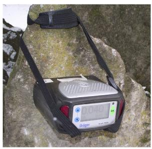
**Figure 5.** Le CO<sub>2</sub> mètre Draeger. La teneur en CO<sub>2</sub> de l'air analysé (jusque 6 %) se lit sur un moniteur à cristaux liquides.
