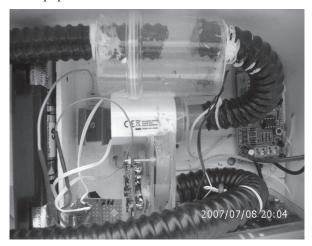
**Figure 7.** Data logger en circuit fermé Do it yourself Omega. Capacité du data logger : près d'un million de données (reproduit avec autorisation de Ek & Godissart, 2013).
