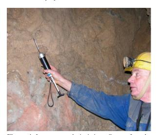
**Figure 4.** La pompe colorimétrique Gastec. Le tube gradué fixé à l'extrémité de la pompe donne en lecture directe la mesure de la teneur de l'air absorbé en dioxyde de carbone.
