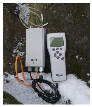
**Figure 6.** Le data logger Vaisala. Enregistrant facilement des mesures toutes les heures ou toutes les trois heures pendant un mois, cet appareil fonctionne en l'absence d'opérateur et donc en l'absence de perturbation anthropique.
