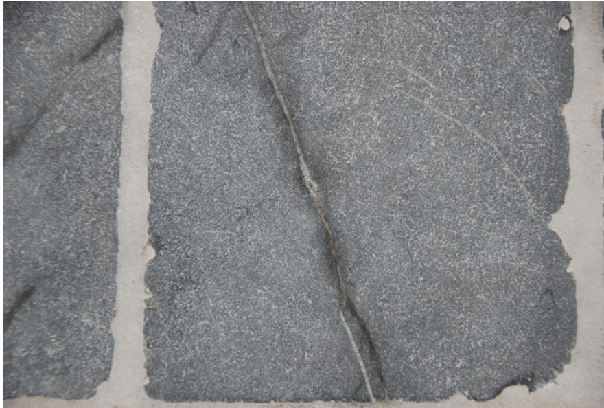
Figuur 3. Grainstone met een fijne witte calcietader die volgens een hoek van ca 60° staat op de kleiige voegen (herkenbaar als korte donkergrijze streepjes). De calcietader vertoont kleine tektonische verspruingen, maar wordt gevolgd door een halfopen barst die meer rechthoekig verloopt, herkenbaar aan de donkere verkleuring door vochtabsorptie.
