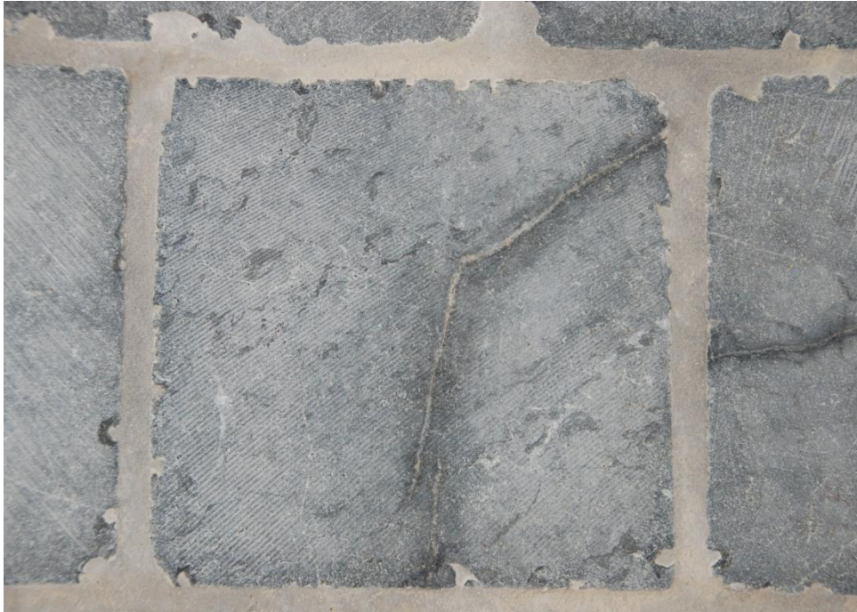
Figuur 7. Platine in grainstone met kleine flasers van meer kleihoudende laagjes die overeenkomstig de interne gelaagdheid van het gesteente van rechtsboven naar linksonder zijn georiënteerd en met een geknikte witte calcieterader die deels de gelaagdheid volgt en deels daar een scherpe hoek mee maakt (van boven naar onder in beeld). Deze ader is niet gebarsten op macroschaal maar vermoedelijk wel op microschaal, te oordelen aan de donkere verkleuring door vochttopslorping rondom dit adersysteem.
