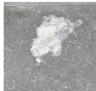
Fig.13. Petit Granit waarin calciet.
