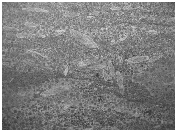
Belgische blauwe hardsteen met crinoiden op uitgeëtst oppervlak (links), Chinese blauwe hardsteen met oolieten (rechts).
