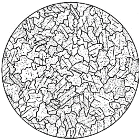
Microscopisch beeld van de gerekristalliseerde kristallen waaruit Carraramarmer is opgebouwd. Er is slechts één mineraal aanwezig, calciet (kalkspaat), met grillig in elkaar grijpende contacten tussen de korrels en met aanduiding van de interne kristalsplijtingsrichtingen (beeldbreedte 3,4 cm, hetzij een gemiddelde korrelgrootte van 3 mm voor de grotere korrels), © Harker (1932).
