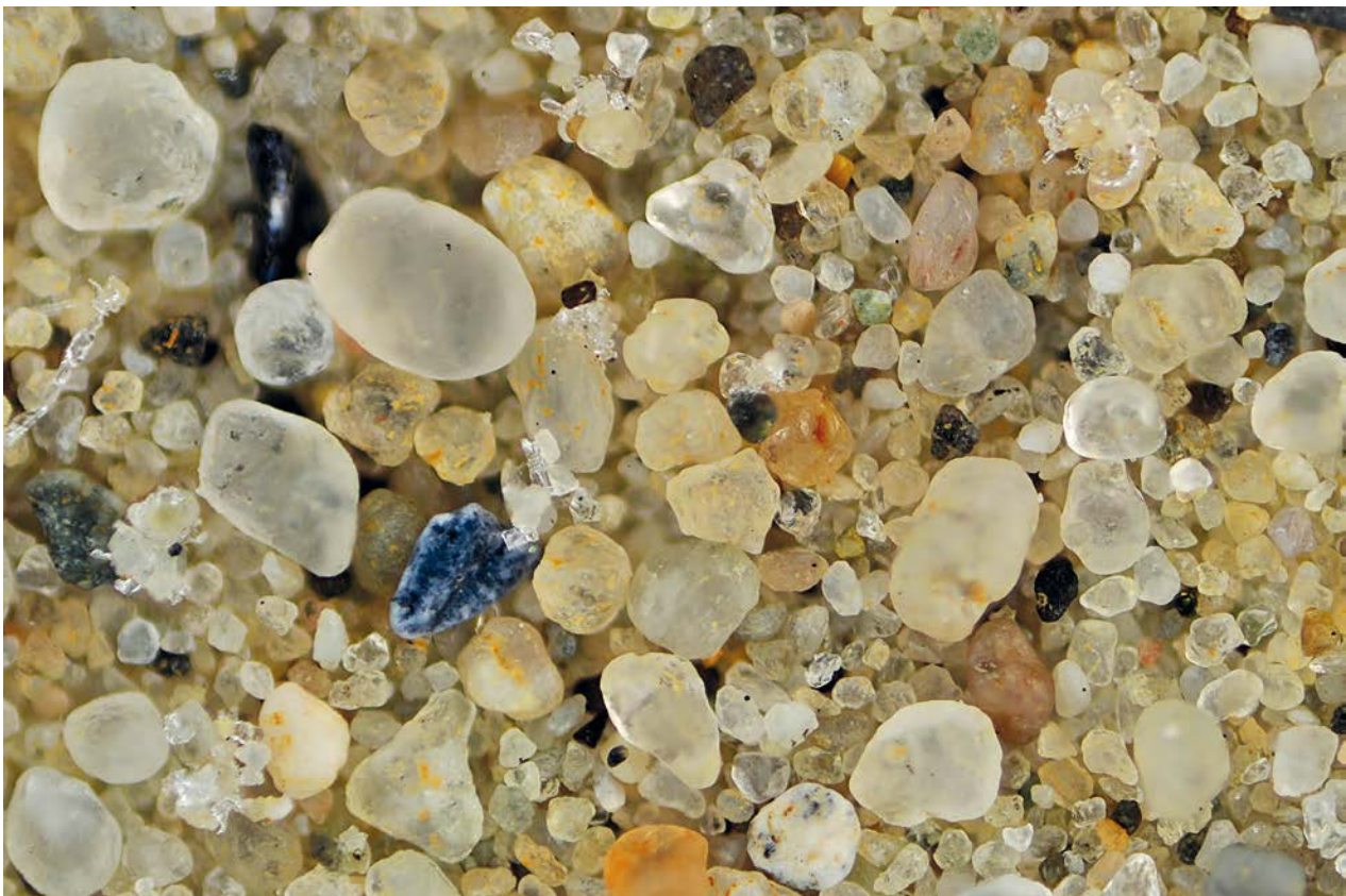
AFBEELDING 5. | Wat kan mat mooi zijn. De eolisch getransporteerde korrels zijn aanzienlijk groter dan de hoekige fluviaal aangevoerde matrix. Het getij heeft de twee populaties vermengd en er lokaal een schelpje bovenop gedaan. Mediane korrelgrootte 250 \mu\text{m} .
