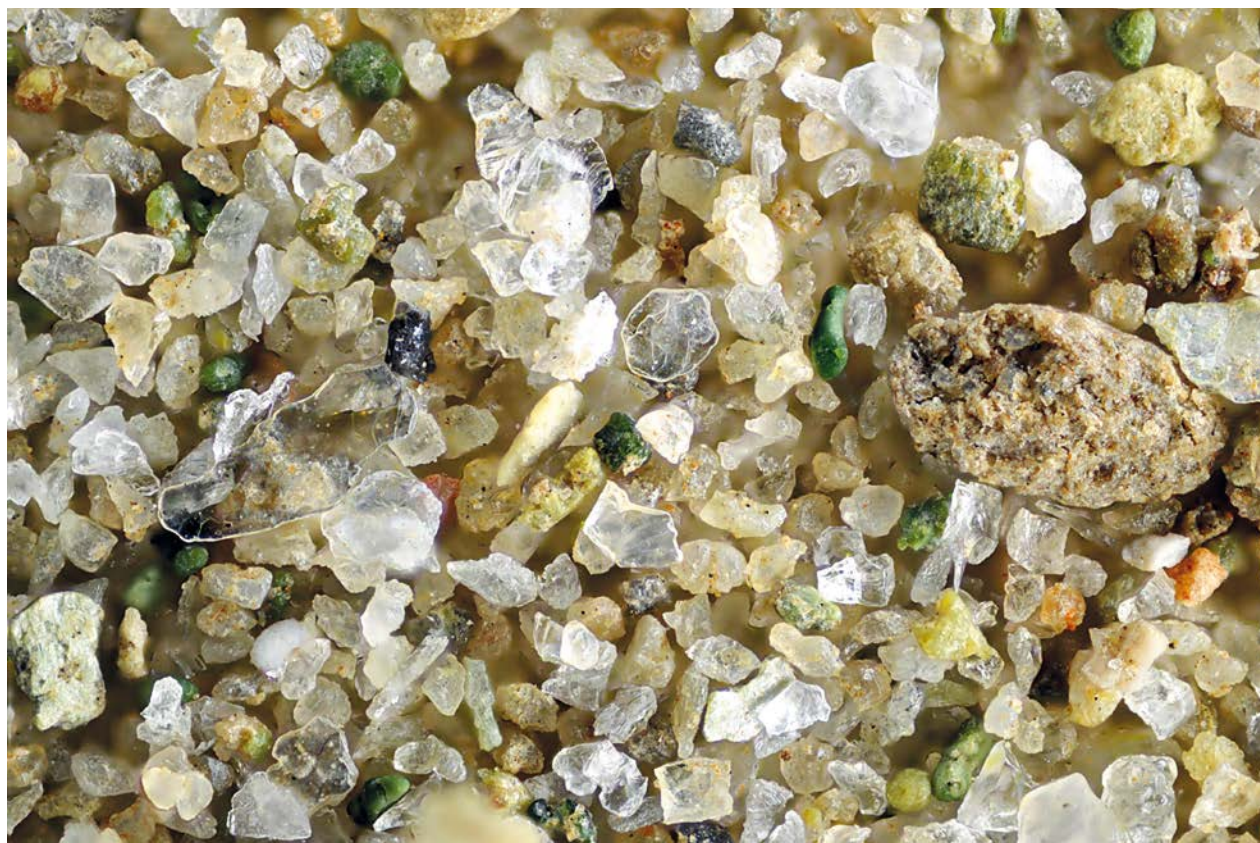
AFBEELDING 3. | Glinsterende glimmers en groen glauconiet ogen nog vers. Samen met de gesteentefragmentjes wijzen ze op beperkt transport na verwerking van het moedergesteente. Mediane korrelgrootte 110 \mu\text{m} .
