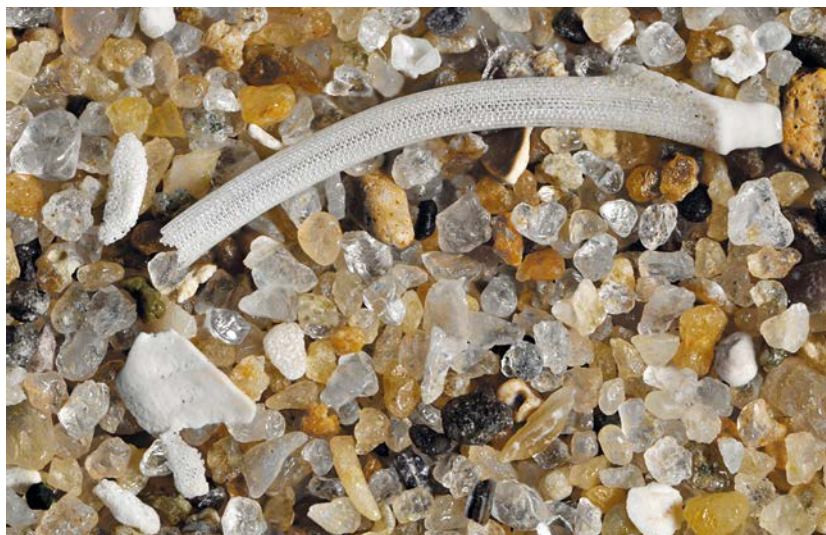
AFBEELDING 2. | Zeeëgelstekel ingebed in zand. Kwarts domineert, met en zonder ijzerverkleuring. Het donkere augiet verraadt een Duitse komaf. Mediane korrelgrootte 215 \mu\text{m} .
