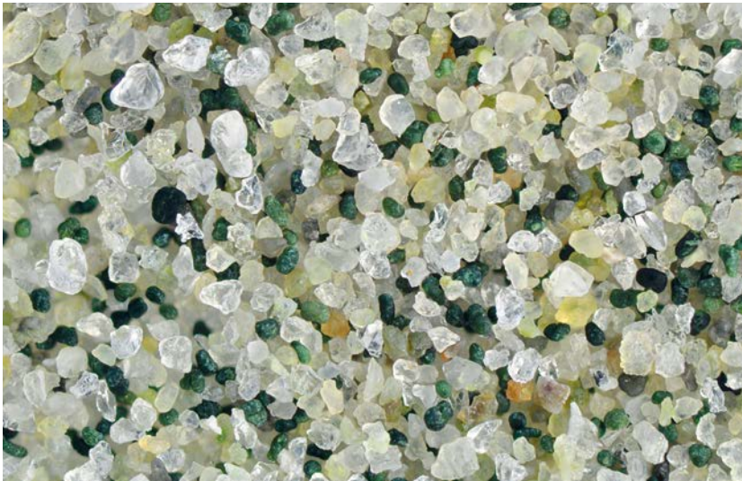
AFBEELDING 4. | Licht radioactief glauconietzand uit de Wielingen, de zuidelijke hoofdgeul naar de Westerschelde. Warm en ondiep water in een kustnabije setting is ideaal voor de vorming van deze micasoort. Mediane korrelgrootte 260 \mu\text{m} .
